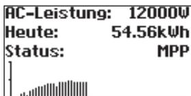
Der Standardbildschirm zeigt die wichtigsten Daten auf einen Blick an. In der ersten Zeile sehen Sie die momentane Einspeiseleistung. In der zweiten Zeile wird die eingespeiste Energie des Tages angezeigt.
