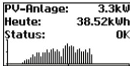
Neben der gesamten aktuellen Anlagenleistung sehen Sie auch den Energieertrag Ihrer Solaranlage sowie etwaige Statusmeldungen aller angeschlossenen Geräte. Diese werden mit der Wechselrichternummer versehen. Ein „M“ bedeutet, dass der Fehler am Hauptgerät aufgetreten ist.
