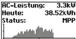
Der Standardbildschirm zeigt die wichtigsten Daten auf einen Blick an. In der ersten Zeile sehen Sie die momentane Einspeiseleistung. In der zweiten Zeile wird die eingespeiste Energie des Tages angezeigt.
